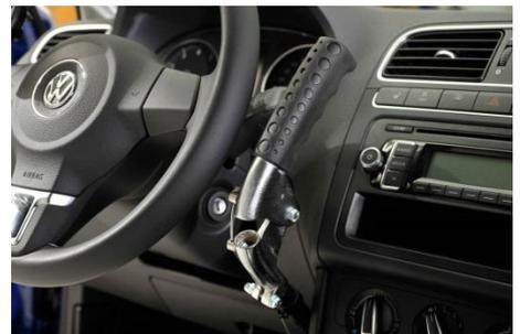
Bei einer komplett beinlosen Bedienung und der entsprechenden Führerscheinauflage (40.11 und 35) empfiehlt sich ein Umbau in Kombination mit dem „Multifunktionslenkraddrehknopf“ Touch
